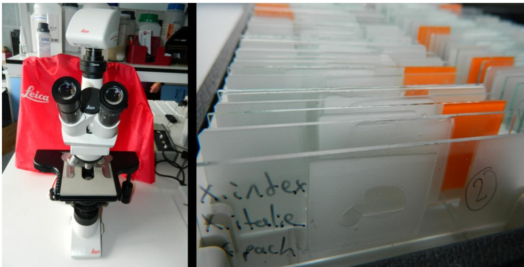
Şekil 3.4. Nematodların tür tanısında kullanılan Leica DM 1000 dijital araştırma mikroskobu, ile hazırlanan ve kaset içinde paketlenen nematod preparatları
