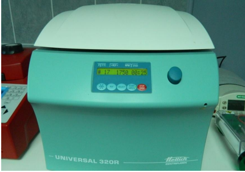
Şekil 3.3. Set üstü Hettich Universal 320 R santrifüj cihazı
